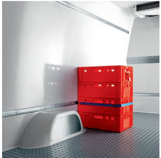
Abb. 2 Airline-Schiene unten (Serie) und oben (optional)
